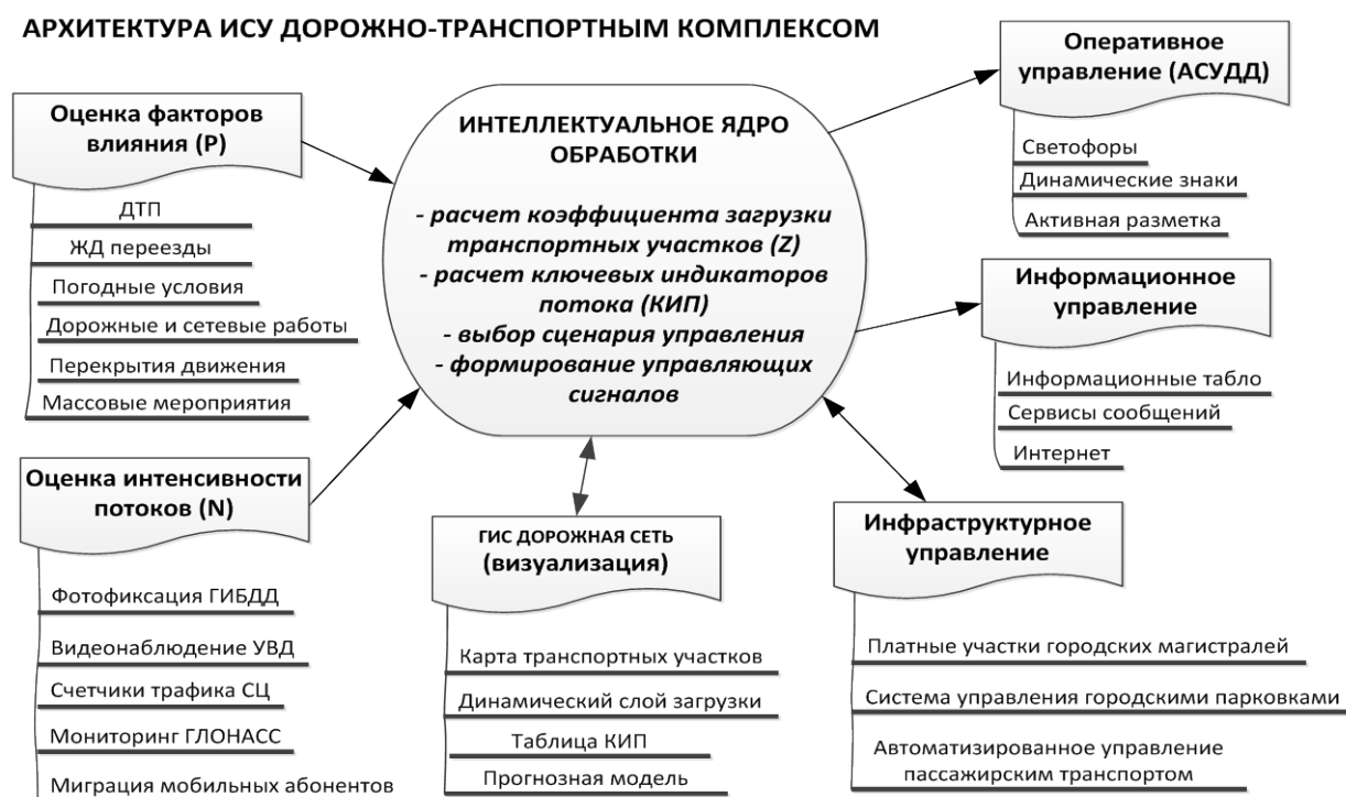
Рис. 2. Архитектура интеллектуальной системы управления дорожно-транспортным комплексом
