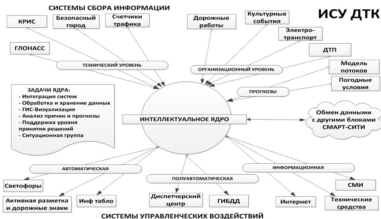
Рис.1. Принципиальная схема интеллектуальной системы управления дорожно-транспортным комплексом
